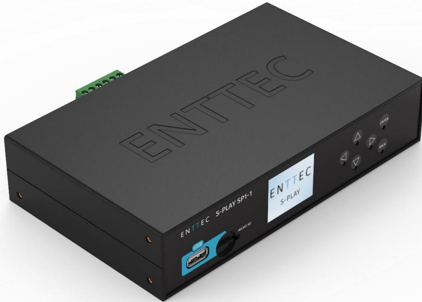
Le S-PLAY d'ENTTEC est un contrôleur de spectacles et un dispositif d'enregistrement/de lecture pouvant rendre jusqu'à 32 univers de spectacles DMX, ou simplement synchroniser plusieurs S-Plays pour de grandes installations.
